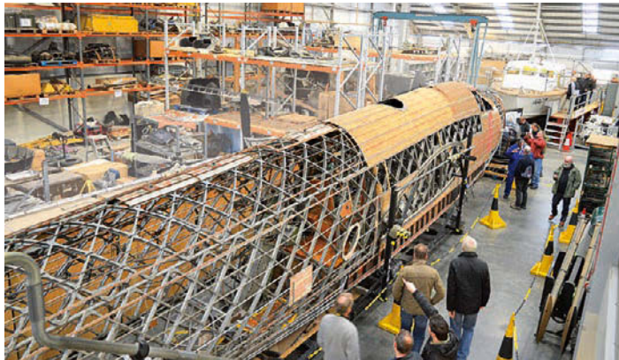
Nach fast 30 Jahren ist der Rumpf der Handley Page Hampden wieder komplett aufgebaut und fertig für die Ausstellung
