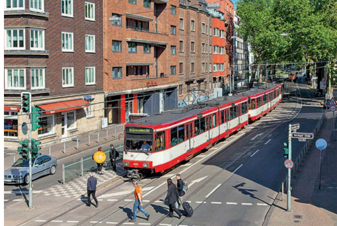
Düsseldorf: Bislang dürfen auf der U78 maximal Drei-Wagen-Züge fahren, ein Ausbau der Infrastruktur für 115 Meter lange, kapazitätsstärkere Vier-Wagen-Züge beispielsweise für Messeverkehr ist in Planung
