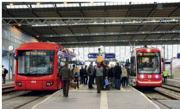
Die bisherigen Zweisystemzüge im Chemnitzer Modell können nur zwischen Dieselbetrieb und Oberleitungsbetrieb umschalten, wie hier am Hbf
