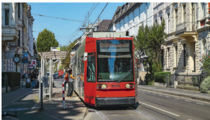
Technisch verschlissen sind die 1994 beschafften 24 Niederflrzüge Typ „Bonn“. Voraussichtlich ab 2022 sollen sie, so die aktuelle Planung, von der nachfolgenden Wagengeneration abgelöst werden
