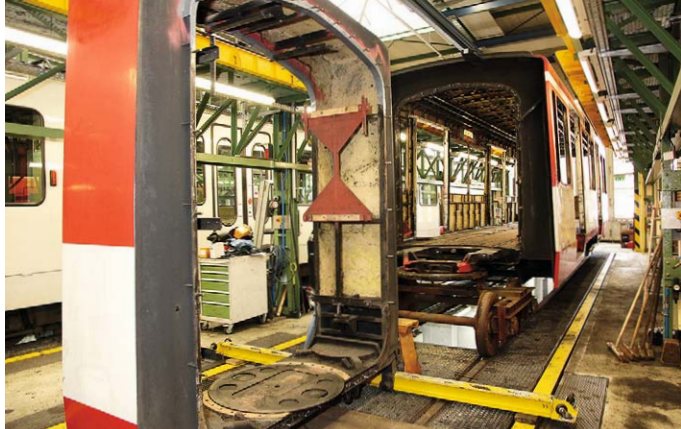
Blick auf einen im Zuge der Zweiterstellung in der Hauptwerkstatt demontierten Gelenkbereich
