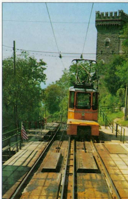
Bild 2. Steilstrecke mit Druckwagen; aus der Blechverschalung kommt das Seil.
