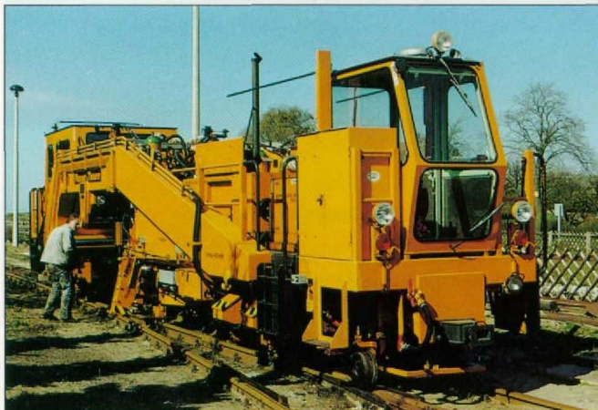
Bild 1. Stopfmaschine auf 900 mm-Spur im Arbeitseinsatz in Kühlungsborn West (10.4.90).
