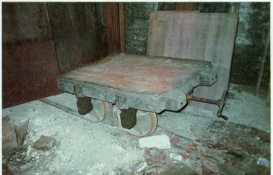
Bild 3. Der urwüchsig anmutende Rollwagen mit deutlich sichtbarer Klotzbremse und Rungenaufsteckvorrichtung. Alle Fotos vom Autor.
