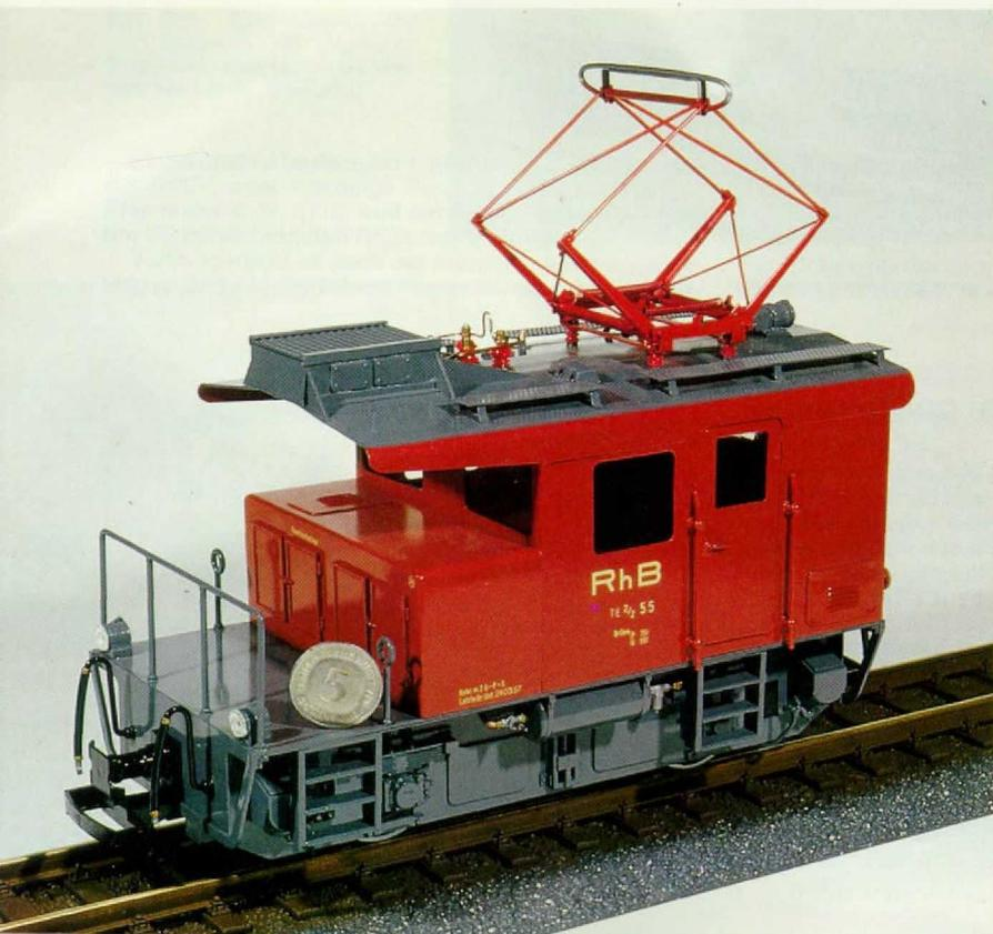
**2m** Bild 255. Trotz seiner Kleinheit (beim Vorbild) ist der Schienenaktor der Rhätischen Bahn von Magnus, im Maßstab 1:22,5, ein imponierendes Modell, wie der Größenvergleich mit dem Fünfmärkstück zeigt.
