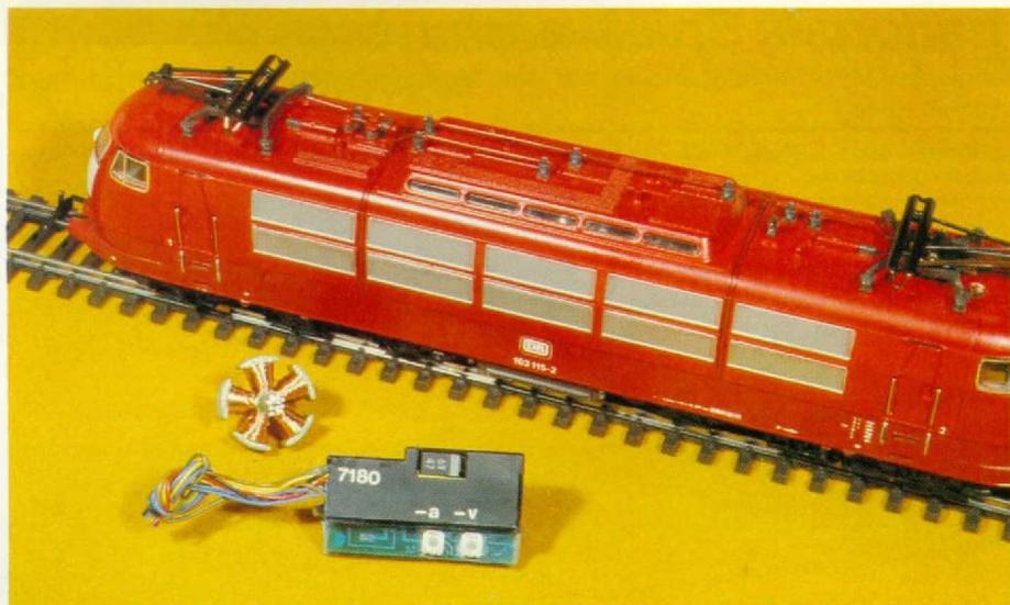
**HO** Bild 240. Sie symbolisieren die neue Märklin-Technik: 103 in neuer Lackierung, neuer Motor mit 5-poligem Anker und Elektronik für den 5-Sterne-Antrieb.
