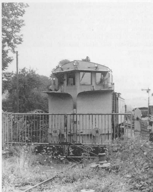
Bild 1. Seitenansicht des Klima-Schneepflugs 949 3204-6 der Deutschen Reichsbahn. Übrigens hat das Wort „Klima“ in diesem Zusammenhang nichts mit dem Wetter zu tun, sondern weist auf die Fahrzeugbauart mit beweglichen Pflugscharen hin.
