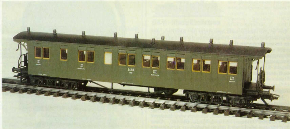
H0 Bild 193. Schnellzug-Großraumwagen à la Länderbahn: Die unsymmetrische Fenstereinteilung des Wagenkastens ergibt sich durch die besondere Raumaufteilung der 2.- und 3.-Klasse-Großraumabteile. Das Modell des württembergischen Personenwagens BC4i Wü00 ist 183 mm lang und mit Kurzkupplung versehen.
