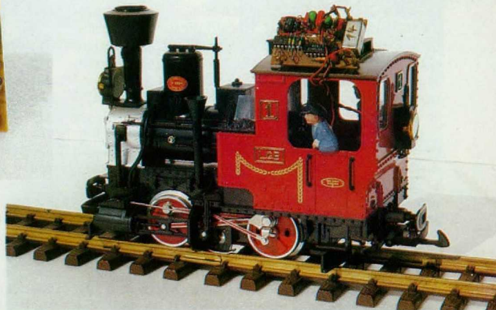
Bild 6. Der Empfängerbaustein wurde hier nur zu Demonstrationszwecken auf das Lokdach gelegt. Von den Abmessungen her paßt er in jede LGB-Lok.
