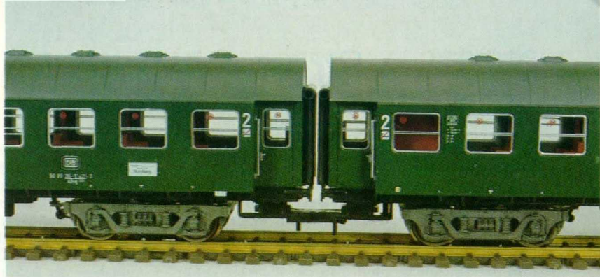
Abb. 3. Wirklich minimal ist der Luftspalt zwischen den Faltenbalgen bei Verwendung der (Roco-)Kurzkupplungsköpfe!
