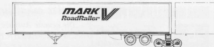
Abb. 3. Für leichtere Achslasten umkonstruiert: Road-Railer mit Drehgestell (Skizze in 1/4 H0-Größe).
