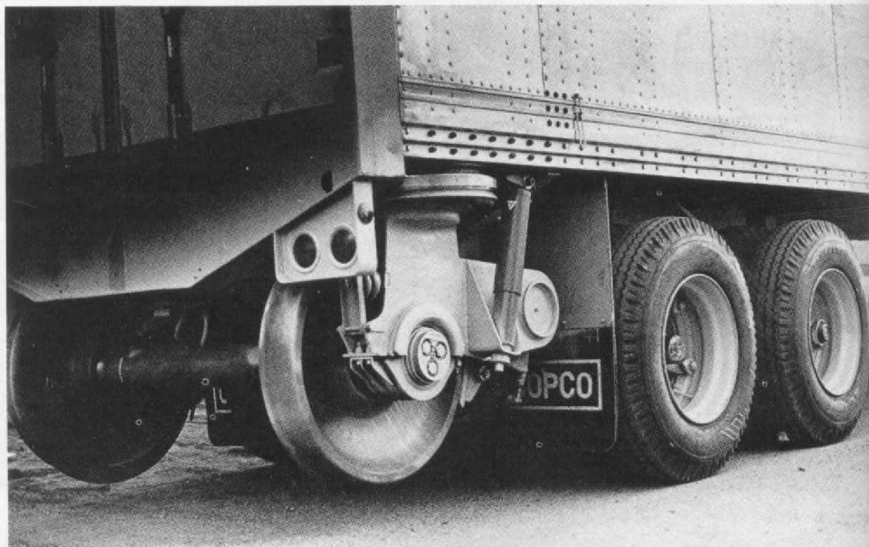
Abb. 2. Die Eisenbahnachse wird im Straßenbetrieb hochgezogen, verbleibt aber bei dieser Version am Fahrzeug.
