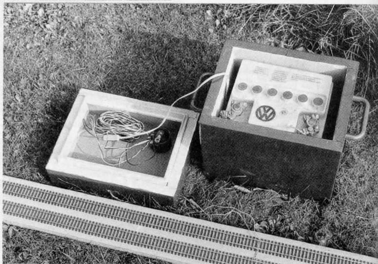
40 Metern. Der Strom wird aus einer 12 V-Autobatterie entnommen, Umschalter und Regler sorgen für die richtige Betriebsspannung. Die Aufbauzeit beträgt inclusive Ausrichten der Unterlegeklötze etwa 10 Minuten, abgebaut ist die „Anlage“ in 5 Minuten.
