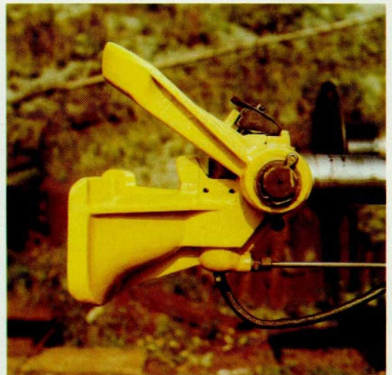
Abb. 5. Die BSI-Kupplung in geöffneter Stellung; eine gewisse Ähnlichkeit mit der Märklin-Bügelkupplung ist unverkennbar.
