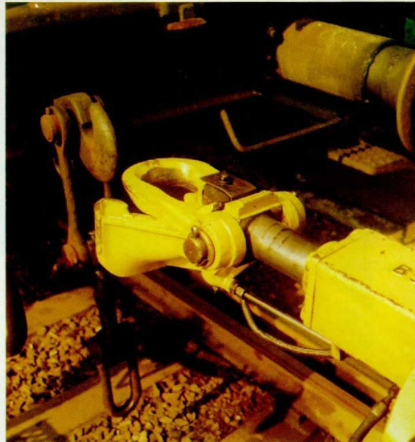
Abb. 3. Beim Einkuppeln schiebt sich der Bügel der BSI-Kupplung über den Zughaken des Waggons; das Fangmaul sorgt dafür, daß Haken und Bügel in der richtigen Position zueinander stehen.
