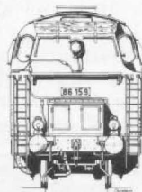
Abb. 1-3. Nicht ohne Grund steht die N-Bauzeichnung der „86“ gleich am Anfang: Im Maßstab 1:160 fehlt ein Großserienmodell dieser vielfältig einsetzbaren Type völlig, worauf bei dieser Gelegenheit nachdrücklich hingewiesen sei: Für ein Modell in dieser „kleinen Größe“ eignet sich die hier gezeigte UK-Version (siehe Haupttext) mit Scheiben-Vorlaufrädern und glatten (geschweißten) Wasserkästen ganz besonders.
