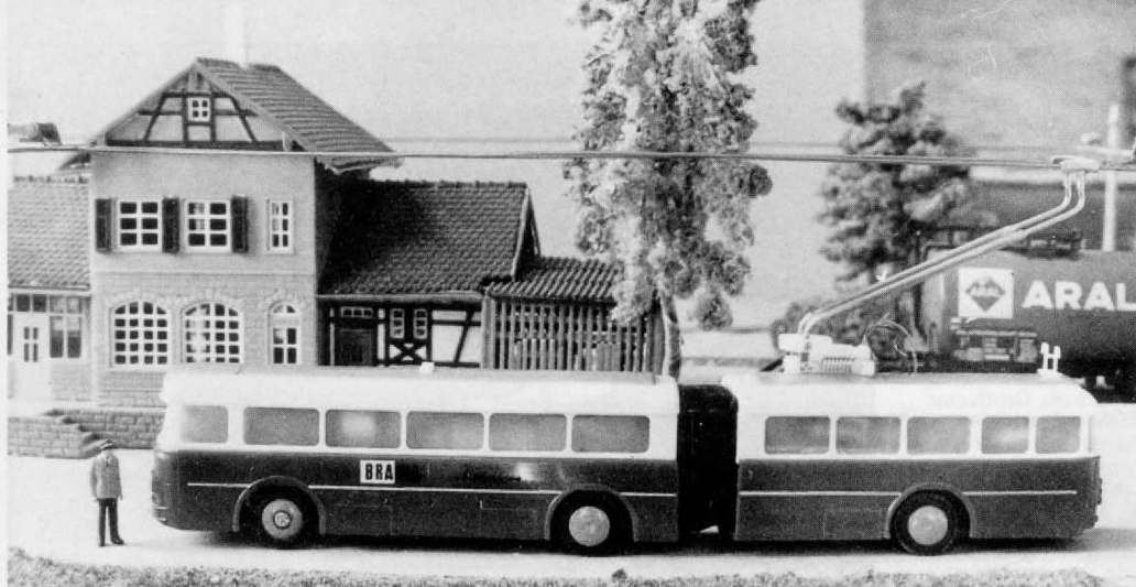
Abb. 1. Das (abgewandelte Brawa-)Modell eines Henschel-16,5-m-Gelenkbusses im Maßstab 1 : 87. Die Stromabnehmer sind hier wie beim Original auf dem Nachläufer angebracht.
