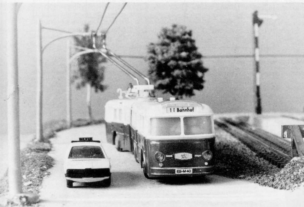
Abb. 2 u. 3. Das Fahrzeug kann ferngesteuert mit variabler Geschwindigkeit vor- und rückwärts fahren und ist mit einer proportionalen Lenkung ausgerüstet, die ein Ausweichen bzw. Überholen an beliebiger Stelle ermöglicht!
