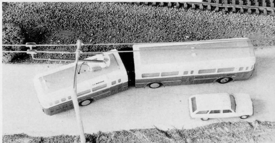
Abb. 2 u. 3. Das Fahrzeug kann ferngesteuert mit variabler Geschwindigkeit vor- und rückwärts fahren und ist mit einer proportionalen Lenkung ausgerüstet, die ein Ausweichen bzw. Überholen an beliebiger Stelle ermöglicht!
