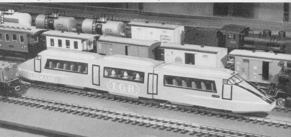
Ilm Abb. 198. Unter dieser schmucken „Schale“ verbirgt sich modernste Antriebstechnik: Das Linear-motor-Versuchsfahrzeug, über das wir in Heft 4/80 berichteten, wurde weiterentwickelt und in dieser Form gezeigt; die Linerarmotor-Studie wird bei Lehmann fortgesetzt.
