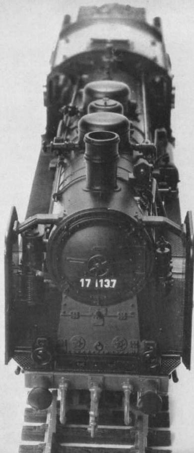
Abb. 5 u. 6. Oben: Stirnansicht des S 10<sup>1</sup>-Modells mit der genauen Nachbildung der Pumpen beiderseits der Rauchkammer und der Schürze vor dem Innentriebwerk. Rechts: die Detaillierung der Lokunterseite und des Führerstands.
