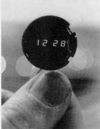
Abb. 2. In ca.  $\frac{1}{4}$  Originalgröße wiedergegeben: das komplette Uhrenmodul.
