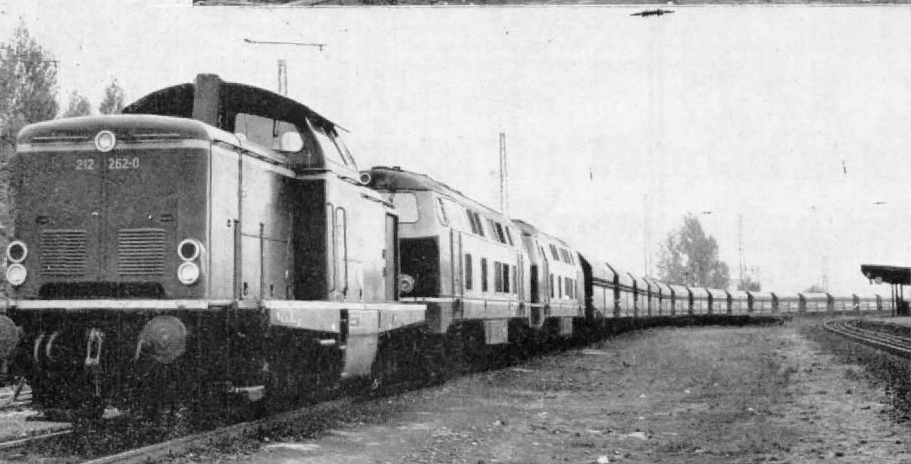
Abb. 8 u. 9. Zwei Elloks der Baureihe 151 in Doppeltraktion vor dem Erz-Ganzzug. An der Pufferbohle der ersten Lok sieht man die automatische Kupplung „Unicupler“. — Auf der nicht elektrifizierten Strecke wird der Zug von einer Lok der BR 212 und zwei Loks der BR 216 — erstmals bei der DB und nur mit Ausnahmegenehmigung — in Dreifachtraktion befördert! Es müssen übrigens nicht sämtliche für die Bespannung des Zuges vorgesehenen Lokomotiven mit der automatischen Kupplung versehen sein, sondern nur diejenigen, die direkt mit dem Wagenzug gekuppelt ist; die Verbindung zu der mit Normalkupplung ausgerüsteten Lok davor erfolgt über eine sog. Notkupplung.
