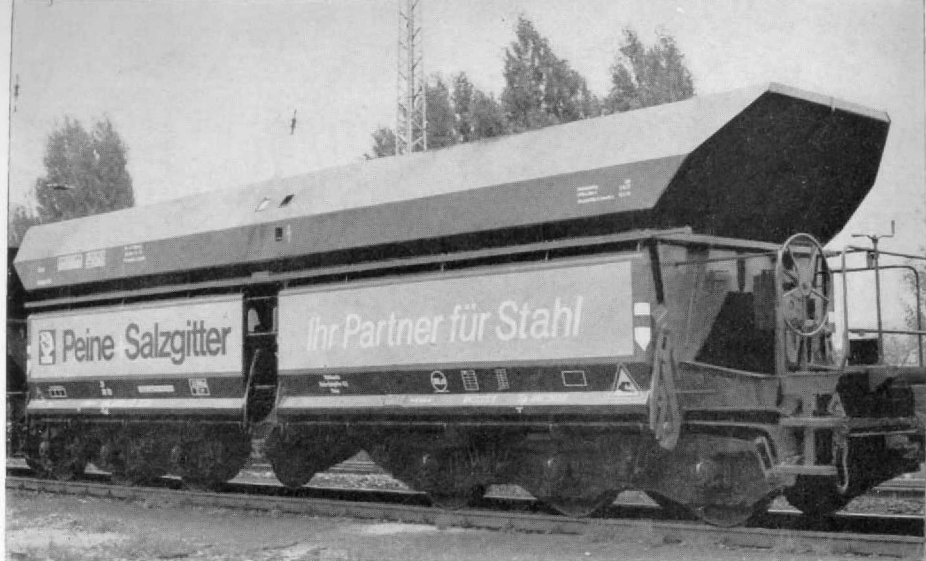
Abb. 1. Der sechsachsige Erzwagen vom Typ Fad 150, hier einer der 180 Privatwagen der Stahlwerke Peine-Salzgitter AG mit der entsprechenden Aufschrift, die auch bei einem eventuellen Modell berücksichtigt werden sollte. Auf der Bühne das Handrad zur Betätigung der Entladeklappen; eine manuelle Bedienung wurde wohl im Hinblick auf den rauen Hüttenbetrieb gewählt.
