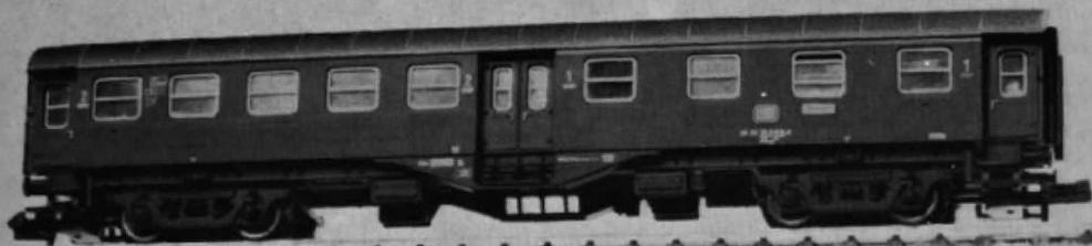
Abb. 4. Das 12,4 cm lange N-Modell des 1./2. Klasse-Umbauwagens vom Typ AByg. Auch am Fahrgestell sind alle Einzelheiten wie Längsträger, Batteriekästen, Bremsanlagen usw. genauestens nachgebildet.
