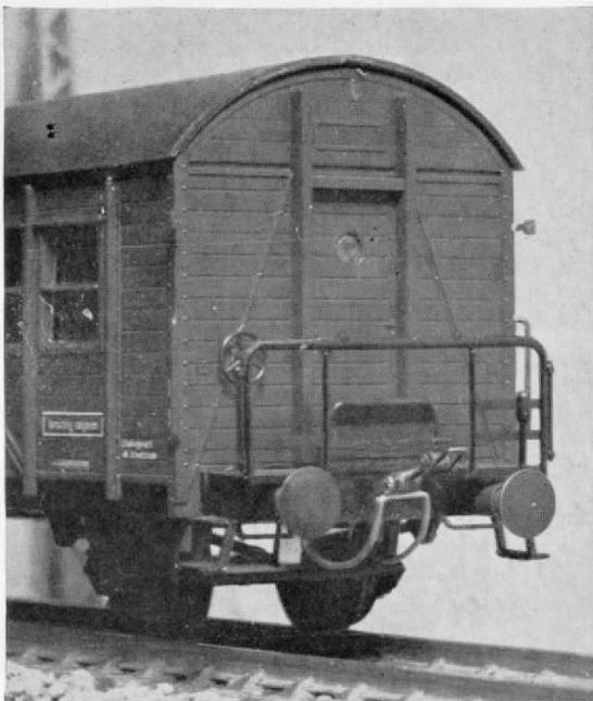
Abb. 1 u. 2. Die Modellkupplung, angebau an einen MCI-Waggon von Röwa. Auf Abb. 1 ist die „Kupplungshubvorrichtung“ (s. Abb. 4 und 5) angehoben, so daß die — „steif gemachte“ — Kupplung leicht nach oben steht; Abb. 2 zeigt sie in Ruhestellung, also senkrecht nach unten hängend.
