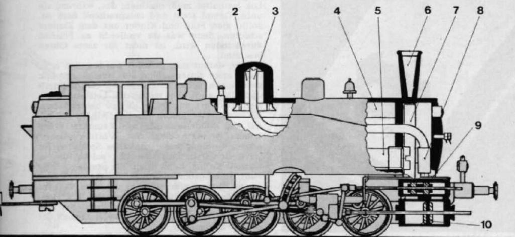
Abb. 5. In dieser Funktions-Skizze vom „live steam“-Modell (in  $\frac{1}{4}$  Originalgröße) sind die wichtigsten Teile erkennbar und gekennzeichnet.
