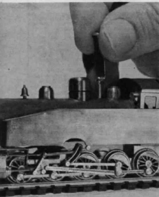
Abb. 4. Mit einem Spezialschlüssel wird der Deckel des Doms geöffnet bzw. fest verschlossen.
