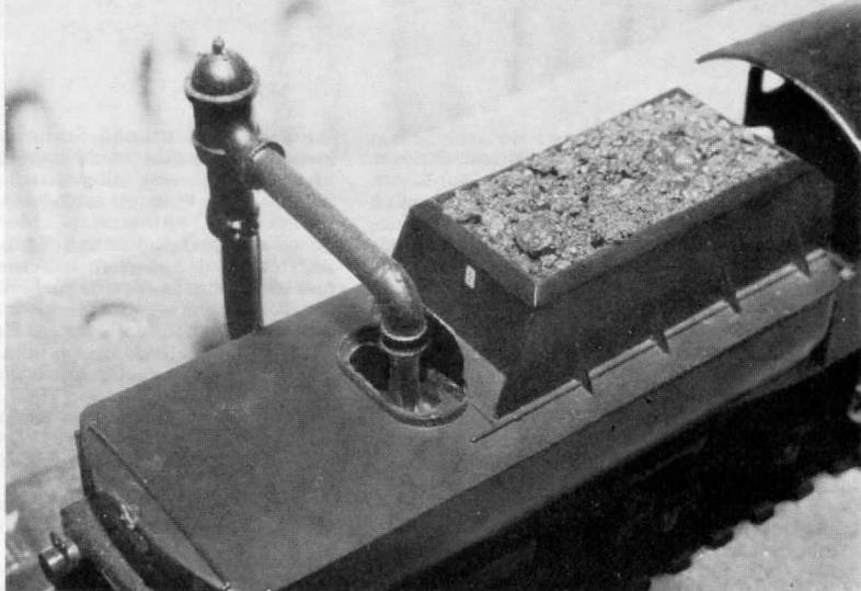
Abb. 7. Die optische Täuschung ist perfekt – wenn der kleine Abfluß-Schlauchstutzen (s. Abb. 8) innerhalb des hinteren Drehgestells mittig angeordnet ist, so daß er von außen nicht gesehen werden kann: der Wannentender während des „Wasserfassens“ in der Seitenansicht.
