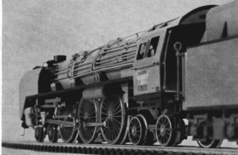
Hinter den nur 0,5 mm starken Windleitblechen verbergen sich die genau nachgebildeten Pumpen. „Selbstverständlich“ ist das Führerhaus mit einer genauen Nachbildung der Stehkessel-Rückwand samt Armaturen versehen. Der Antrieb befindet sich im Tender und treibt die letzten drei, mit Haftreifen versehenen Achsen an; die vorderen zwei Achsen sind vorbildgetreu in einem Drehgestell zusammengefaßt. Der 5-polige Motor hat
