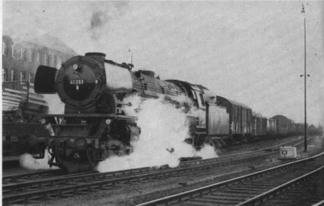
Abb. 3. Aus dieser Aufnahme geht das kraftvolle Aussehen der Neubaukessel-41 besonders deutlich hervor: die kohlegefeuerte 41 293 setzt im Bahnhof Wanne-Eickel einen Güterzug in Bewegung. (Foto: K. D. Holzborn, Heilbronn)
