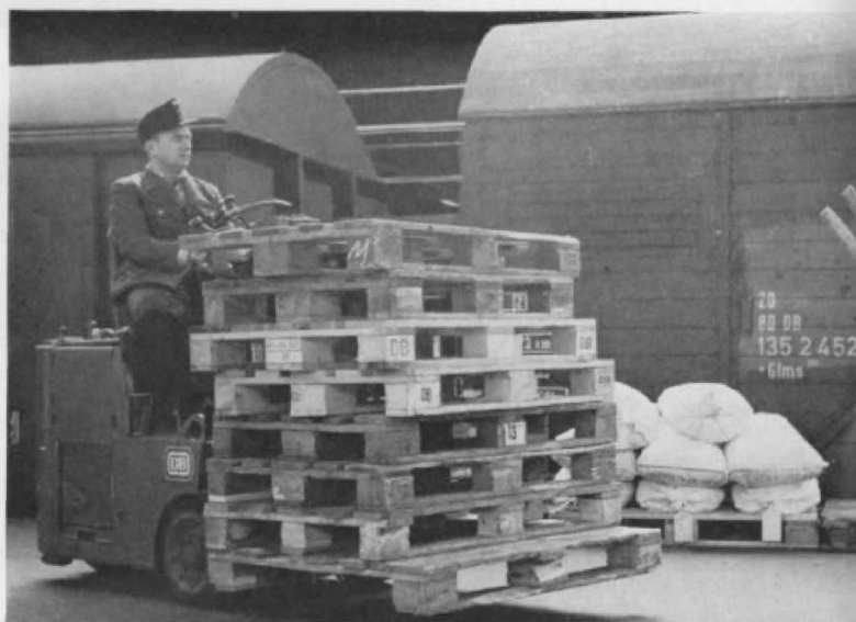
Abb. 7. Die standardisierte Pool-Flachpalette mit den Abmessungen 1200 x 800 x 144 mm (H 0 : 14 x 9 x 1,5, N: 7,5 x 5 x 0,9 mm), die im Modell aus dünnem Holz und ein paar Leistenstückchen leicht zusammengeklebt werden kann.
