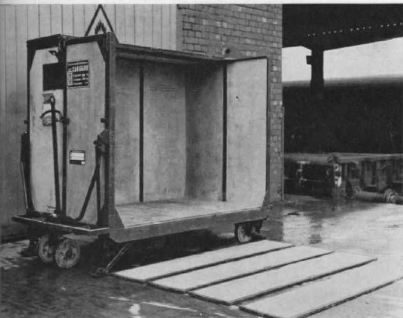
Abb. 3. Zum Beladen der Kleincontainer kann eine Seitenwand herausgenommen und der „Deckel“ aufgeklappt werden. Die Kleincontainer sind mit einem eigenen, 4-rädrigen Fahrwerk ausgestattet, das nach Beendigung des Verladevorgangs bzw. zum Abstellen arretiert werden kann. Hier der Typ C mit 3 m 3 Laderaum.
