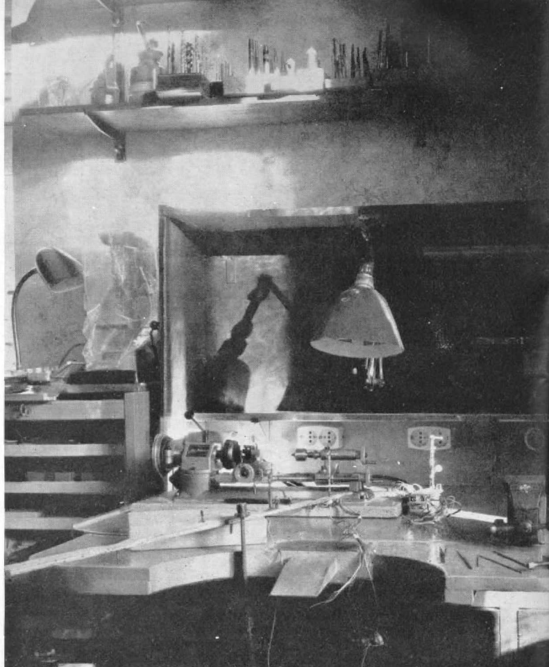
Abb. 1. „Der Arbeitsplatz des Modellbahners“ — in diesem Fall die Arbeitsecke des Herrn Meyer. Drei wichtige Punkte fallen sofort ins Auge: die Vorsteckplatte mit dem Halbkreis-Ausschnitt und dem daran angebrachten „Feilnagel“ (Abb. 3), die auszieh- und schwenkbare Arbeitslampe und die mehrfachen Steckdosen.
