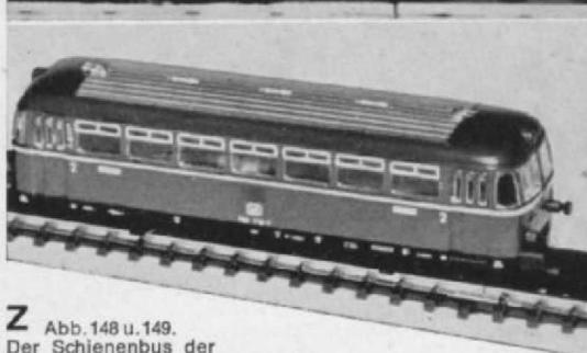
Z Abb. 148 u. 149. Der Schienenbus der BR 798 als 6,2 cm langes Z-Modell. Aus der oberen Abbildung (ca. 3-fache Originalgröße) geht hervor, wie lückenlos die eingespritzten Fenster in den Rahmen sitzen.
