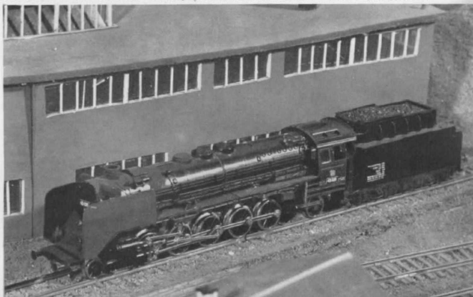
Abb. 5. Zur weiteren Verstärkung der Zugläufe (und zugleich zum x-ten Mal als Umbau-Anregung): eine „45“ aus zwei „65“-Fahrgeräten und zwei „01“-Kesseln. Der aushilfsweise angekuppelte „01“-Tender wird in Kürze durch den nunmehr erhältlichen 5-achsigen Kohle-Triebtender von M + F (s. S. 580) ausgetauscht!
