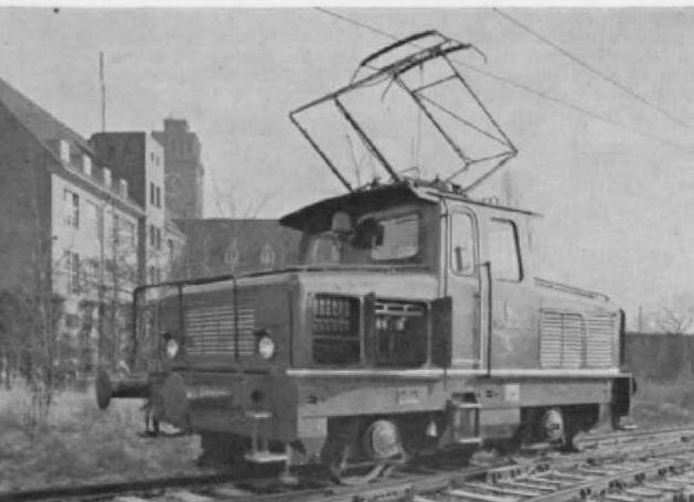
Abb. 1. Auf der Siemens-Güterbahn in Berlin verkehrt diese 600 V-Ellok (Achsfolge Bo) mit 2 Motoren à 230 kW. Man beachte die große Glocke zwischen den beiden Frontenstern!
