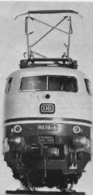
Abb. 2. Die Stirnansicht zeigt weitere Details wie die exakt passende Verglasung mit (auf dem Gehäuse fortgesetzten) Scheibenwischer-Nachbildungen, Schlauchanschlüsse unter den Puffern usw.
