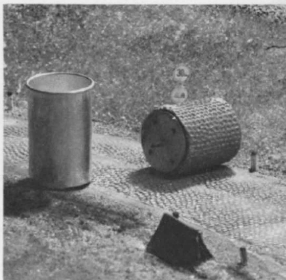
Abb. 1. Die „Straßenpflaster-Prägewalze“ des Herrn Schulz auf einem Kopfsteinpflasterstück nebst einer Kleinbild-Filmbüchse, aus der sie entstand. Die Walze wird an den Achsstummeln mit den Fingern geführt.
