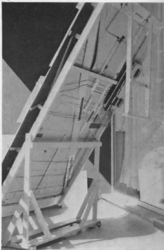
Abb. 4. Die Anlage im halbgekippten Zustand. Das Untergestell mag etwas „primitiv“ (lies: „einfach“) wirken, ist aber stabil genug und durchaus zweckgenügend.
