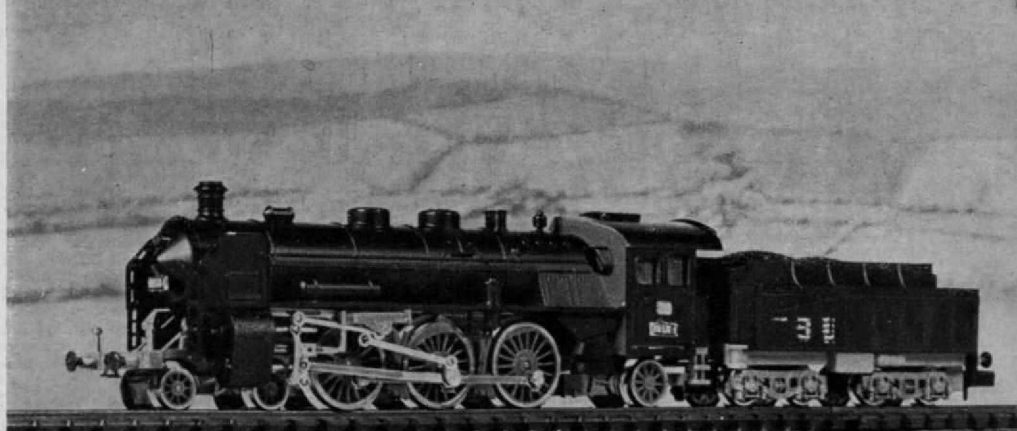
Abb. 7 u. 8. Die S 3/6 (BR 18 a der DB, im Gegensatz zu einer 18 b mit geradem Führerhaus), ein sehr schönes Modell mit einer sehr feinen Steuerung, wie man sie noch vor Jahren in N für unmöglich gehalten hätte, aber auf Grund der mit den Spurkränzen zusammenhängenden Probleme etwas länger als maßstäblich richtig wäre.
