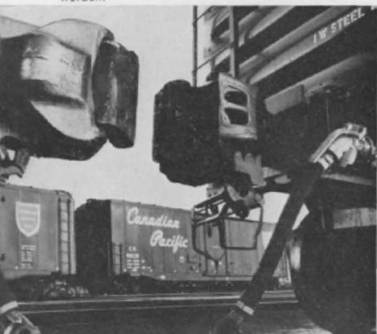
Abb. 9. Eine eindrucksvolle Aufnahme von der amerikanischen Klauenkupplung, die der bekannten Kadee-H0-Kupplung nachgebildet ist. Hier müssen die Steuerleitungen (im Großen) nach von Hand verbunden werden.
