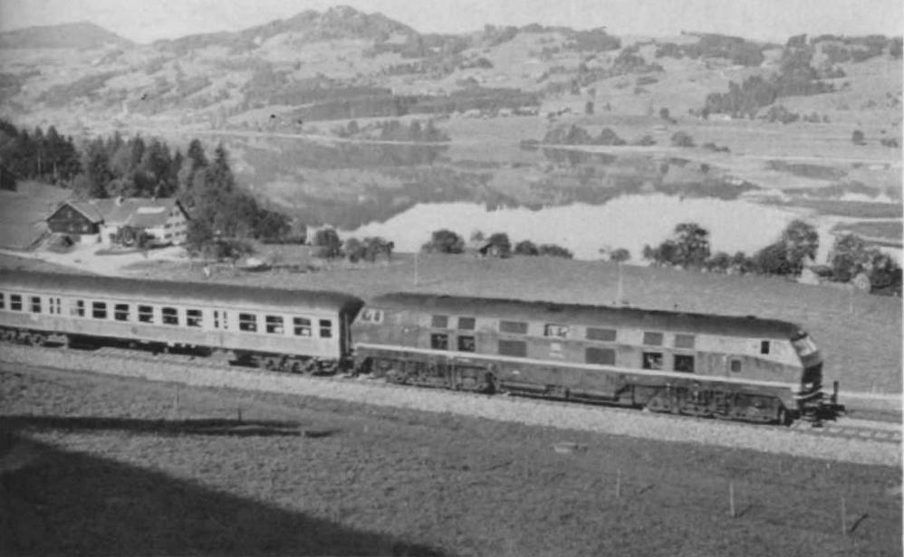
Abb. 3. Die V 320 vor einem Personenzug — bestehend aus zwei Nahverkehrswagen und einem Gepäckwagen — zwischen Immenstadt und Kempten. Auffallend, wie „kurz“ der 26,4 m-Wagen gegenüber dem Lok-Giganten wirkt. (Foto: H. Hilll, Oberdorf)
