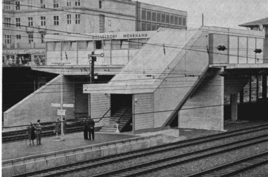
Abb. 1. S-Bahnhof Düsseldorf-Wehrhahn — an eine Straßenüberführung angebaut. Zugang zum Bahnsteig über die Treppe, Ausgang über die danebenliegende Rolltreppe.
