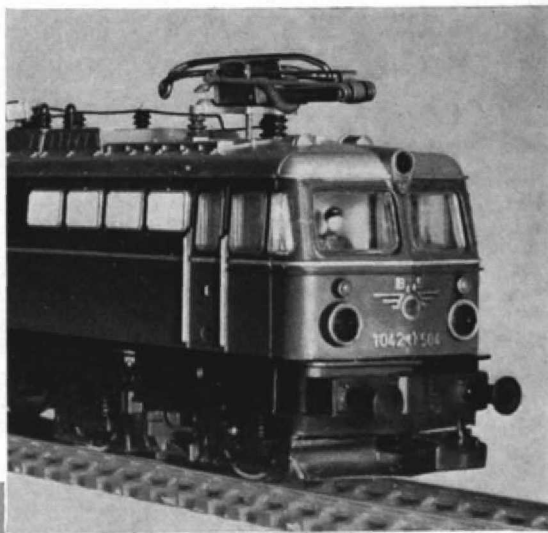
Abb. 1. Eine der beiden Führerhauskabinen mit dem minutiös nachgebildeten Armaturenbrett (einschließlich Handrad). Der Führer – eine amputierte Preiser-Figur – wurde von uns „in Dienst gestellt“. Die Kabine läßt sich nach Abnehmen des Lok-Gehäuses durch Druck auf die Plexiglasstäbe aus den Lampenhalterungen herausdrücken.
