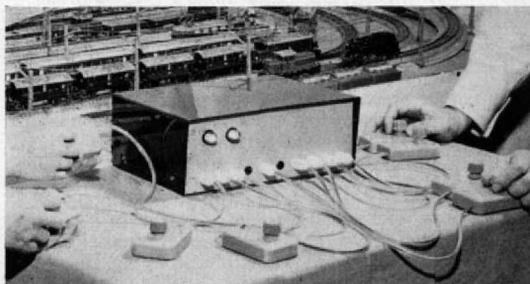
Abb. 1. 8 Steuergeräte sind hier an die Zentrale des Rot-Systems angeschlossen. Um „steuerliche Mißgriffe“ zu vermeiden, ist es empfehlenswert, auf die Steuerkästchen Etiketten zu kleben und diese entsprechend der jeweiligen Lok zu beschriften (besonders wichtig bei Mehrfachbelegung eines Steuerkanals, z. B. Lok und Kran o. dergl.; s. a. S. 114).
