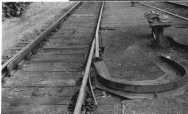
Abb. 4. Die eine Hälfte der Anlage. Deutlich ist die Ausweiche für den Hemmschuh zu sehen. Damit der Wagen nicht auch den Weg in diese Ausweiche nimmt, wird er durch die Leitschiene am linken Schienenstrang im Gleis gehalten. Diese Leitschiene kann im Modell eventuell gleich noch als Kontaktgeber (z. B. zum Stellen der Weichen) verwendet werden (!). Rechts oben der Hemmschuhständer.
