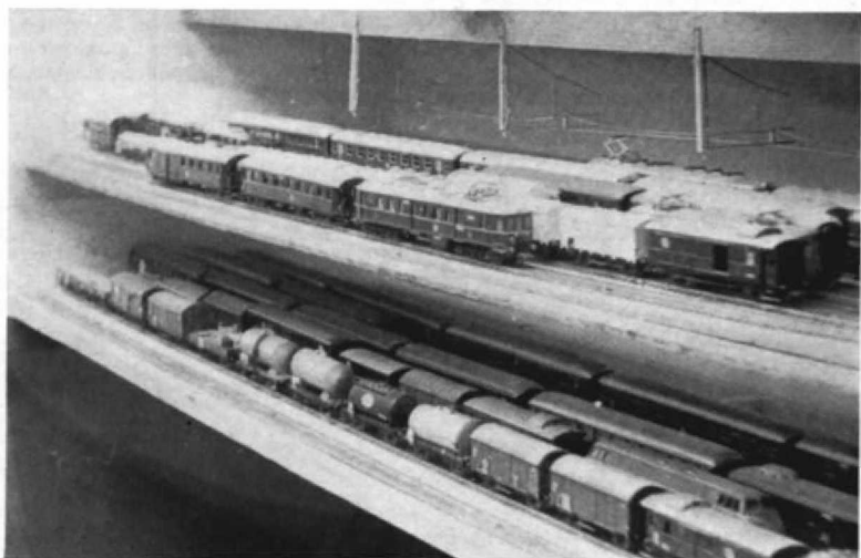
▼ Abb. 3. Auf den 14 Abstellgleisen finden eine Menge Fahrzeuge Platz und können bei Bedarf doch schnell in das Gleisnetz eingeschleust werden. Es ist nur ein Gleis mit Oberleitung verspannt. Die Stromabnehmer müssen vor dem Verschieben der Platte niedergedrückt werden, wenn man nicht ein ähnliches Prinzip wie bei der Drehscheiben-Oberleitung anwenden will (s. Heft 10/XVII).
