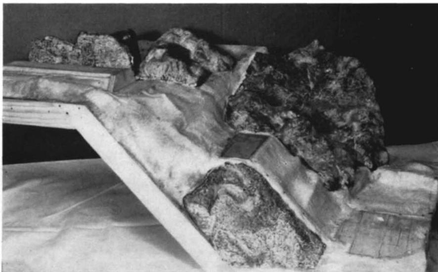
daß er zwar nicht mehr durch die Gaze tropft, aber doch noch um die einzelnen Drähte herumquillt. Dadurch ergibt sich gewissermaßen eine Verklammerung der Moltofill-Schicht mit dem Draht-Geflecht. Insbesondere bei transportablen Anlagen kann das von Vorteil sein, weil bei diesen die Beanspruchung der modellierten Flächen beim Transport gegenüber einer stillstehenden Anlage wesentlich größer sein kann.
