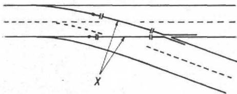
das die isolierten Schienenstücke der Weichenstellung entsprechend mit Fahrstrom versorgt bzw. abschaltet, falls die stromlosen Schienenstücke für eine ordnungsgemäße Stromabnahme zu lang ausfallen. Den gleichen Effekt kann man auch mit zusätzlich am Weichenantrieb angebrachten Kontakten erreichen.
