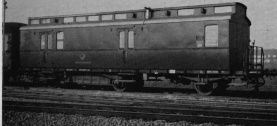
Abb. 10. Das Vorbild unserer heutigen Bauzeichnung (Abb. 8), der Post 3 mit Bremserstand. Dieser Wagen wurde 1925 von Orenstein & Koppel, Berlin, gebaut. (Foto: H. Meißner, Münster)
