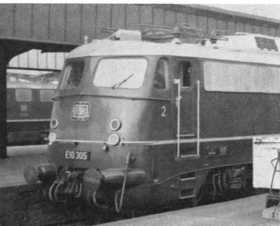
Abb. 1. Die E 10 305 ist eine der Loks mit dem neuen, schnittigeren Lokkasten. Beachten Sie bitte die „Bügelalte“ in der Mitte der Stirnwand, sowie die am „Bug“ vor den Drehgestellen stark eingewölbte Schürze.
