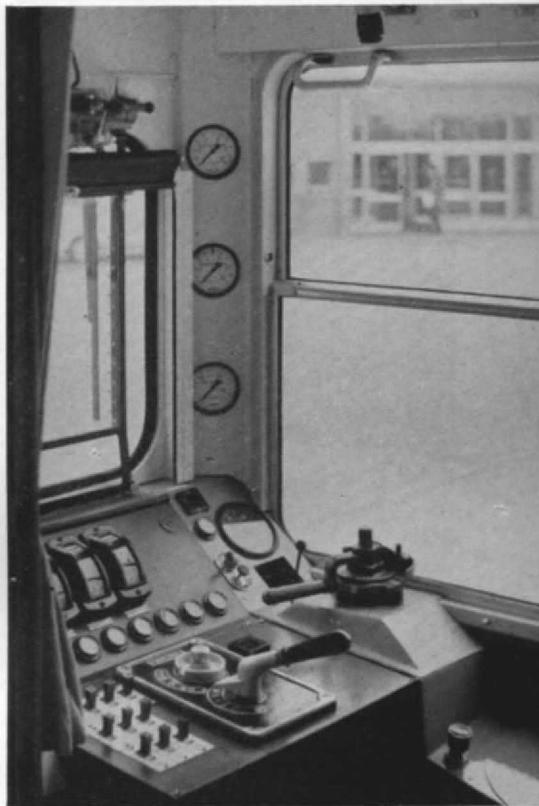
Abb. 3. Blick in das Führerabteil eines Wendezugsteuerwagens neuerer Bauart (BD4nf, also ein 2.-Klassewagen mit Dienstabteil, übrige Beschriftung wie Abb. 1).
