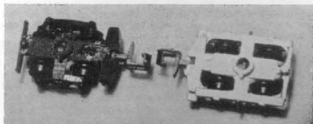
Abb. 4 und 5. Die neuen Drehgestelle (links amerikanischer Bauart, rechts Minden-Deutz), zwar etwas vereinfacht und verkürzt, jedoch trotz der Kleinheit gut detailliert, beide mit der neuen Kupplung; beim MD-Drehgestell ist der obere Pinn für die bisherigen Kupplungen weggeknipst worden.
